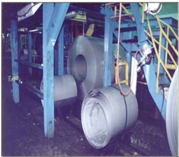
Figura 1. Bobinas de acero aceitadas luego del proceso de decapado.
