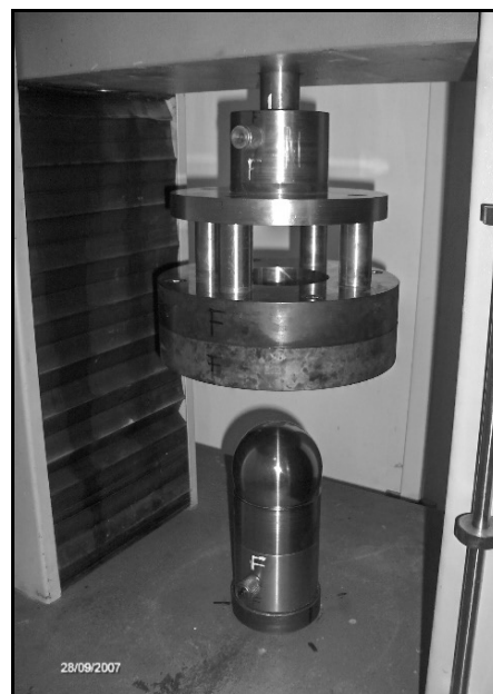
Figura 2. Equipo usado para determinar la curva límite de formabilidad.
