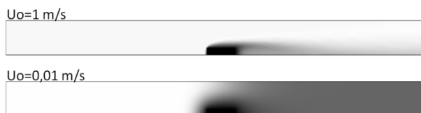
Figura 5. Distribución de temperaturas en el reactor tubular para U_0 : 0,01 y 1 \text{ m.s}^{-1} . T_{\text{sus}}=1400 \text{ K} . Color oscuro indica valores altos.
