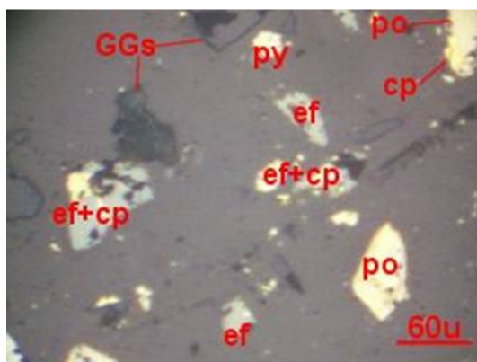
Figura 1: Microfotografías de minerales de calcopirita (cp), de pirrotita (po), de esfalerita (ef), de pirita (py) y de gangas (GGs); además partículas entrelazadas de calcopirita (cp) con la esfalerita (ef) y calcopirita (cp) con la pirrotita (po). Nícoles Paralelos - 200X.
