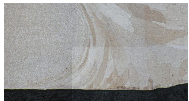
Figura 5. Transición entre la ZA y ZTMA en el lado de avance, condición Vs-Vr: 125-1250.
