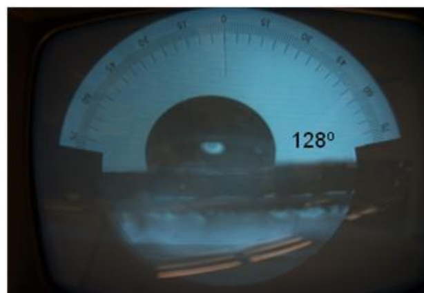
Figura 7. Imagen de la prueba de ángulo de contacto de los MWNTC's- ácido acético tratados por ultrasonido.
