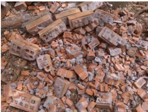
Figura 1. Ladrillo de arcilla y mortero de cemento (RM).
