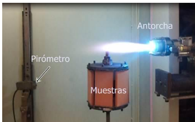
Figura 1. Imagen del portamuestra, pirómetro y de la antorcha Terodyn 2000 TM. Fuente: grupo GIPIMME Universidad de Antioquia-Colombia.
