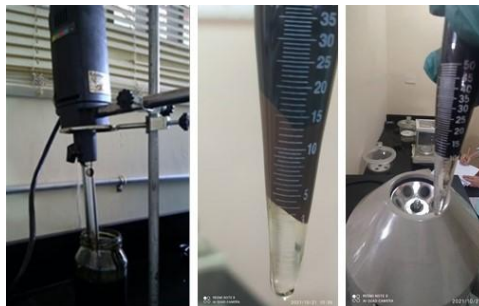
Figura 1. Homogeneización de las muestras (izq.). Medición del contenido de agua y sedimentos por centrifugación (der.) y visualización de la apariencia, tipo y cantidad de fases (centro).
