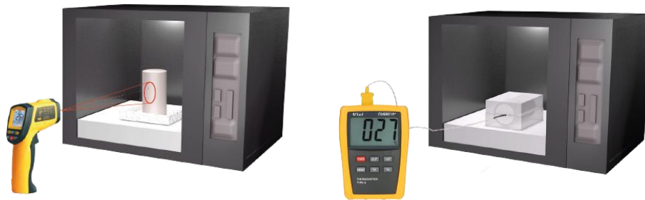
Figura 4. Sistemas de medición de temperatura. Pistola láser F-62 y termopar Tipo K de izq. a dcha. Respectivamente.
