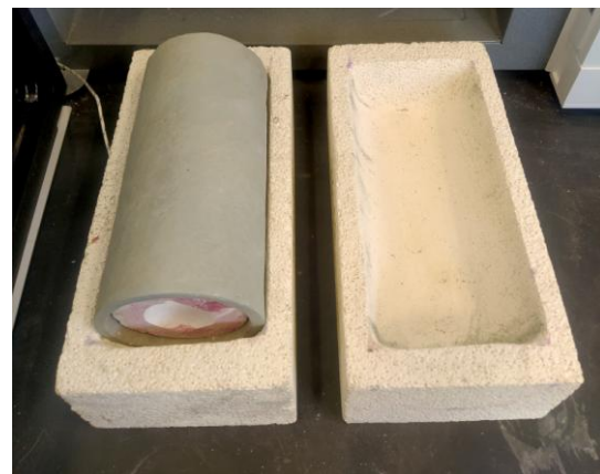
Figura 6. Fotografía de la mufla microondas abierta con el molde dentro
