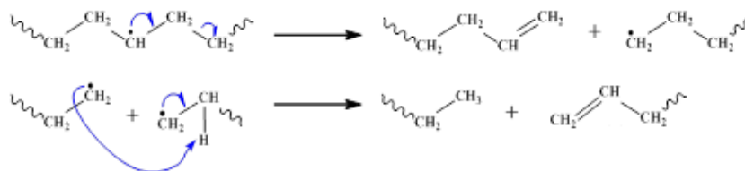
Figura 9. Mecanismos propuestos para la formación de insaturaciones vinílicas terminales como reacciones colaterales al modificar polietilenos en presencia de peróxidos [47].
