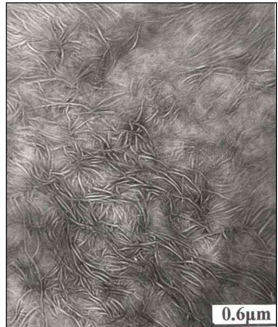
**Figura 6.** Microfotografía MET del PEAD funcionalizado después de aplicarle el tratamiento 2.
