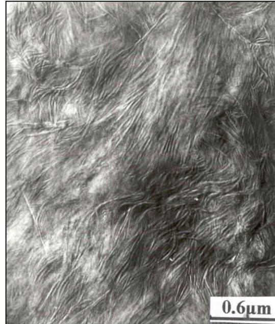
Figura 9. Microfotografía MET del PEAD original después de aplicarle el tratamiento 3 con una velocidad de enfriamiento de 20°C/min.
