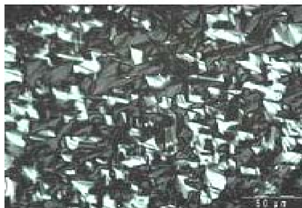
Figura 15. Micrografía óptica de polarización mostrando la textura de cristal líquido.
