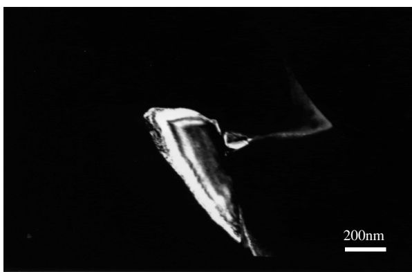
Figura 9A. Imagen de campo oscuro, -3°, 50.000X de fase identificada como Fe 2 O 3
