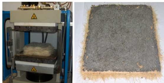
Figura 1. Obtención del material compuesto en la prensa de platos calientes.
