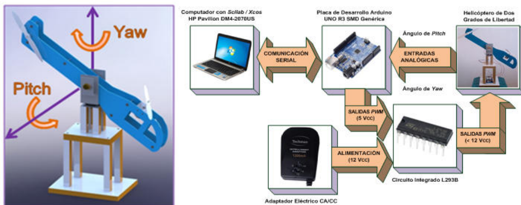
Figura 1. Prototipo de H2-GdL con ejes de rotación y diagrama de bloques del SAD&C
