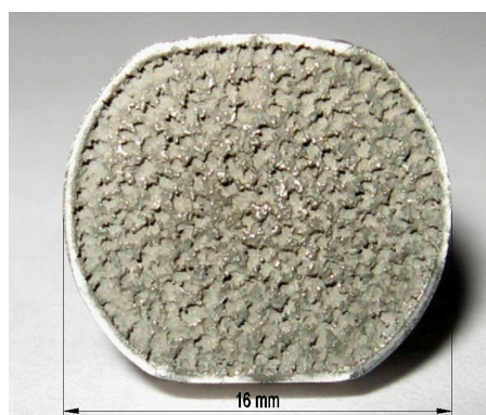
Figura 2. Fotografía de cara de probeta ensayada mediante método de ultrasonido en Laboratorio Metalurgia UTN Regional Mendoza, se observan cavidades de conformación irregular uniformemente distribuidas.
