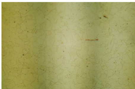
Figura 13. Microestructura del material, formada por austenita (200X).
