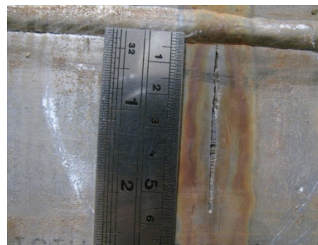
Figura 6. Detalle de serie de picaduras verticales.
