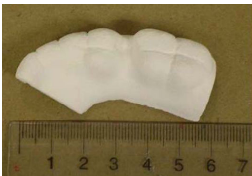
Figura 17. Muestra de HA impregnada con bis-GMA [33].
