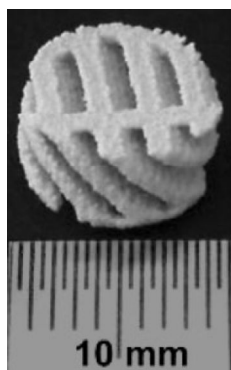
Figura 10. Andamio de HA después de sinterizado [28].
