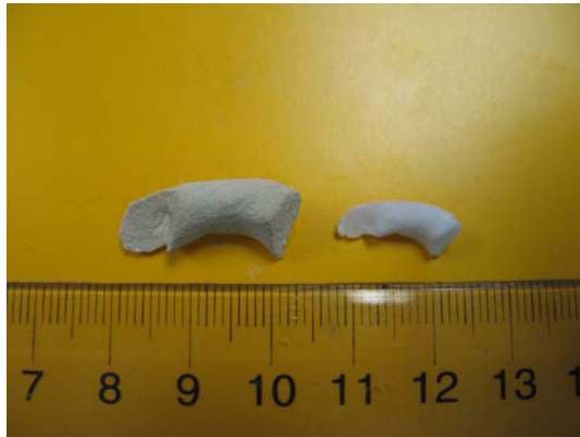
Figura 21. Modelos de hueso mandibular a verde y sinterizado de HA fabricados por 3DP [37].
