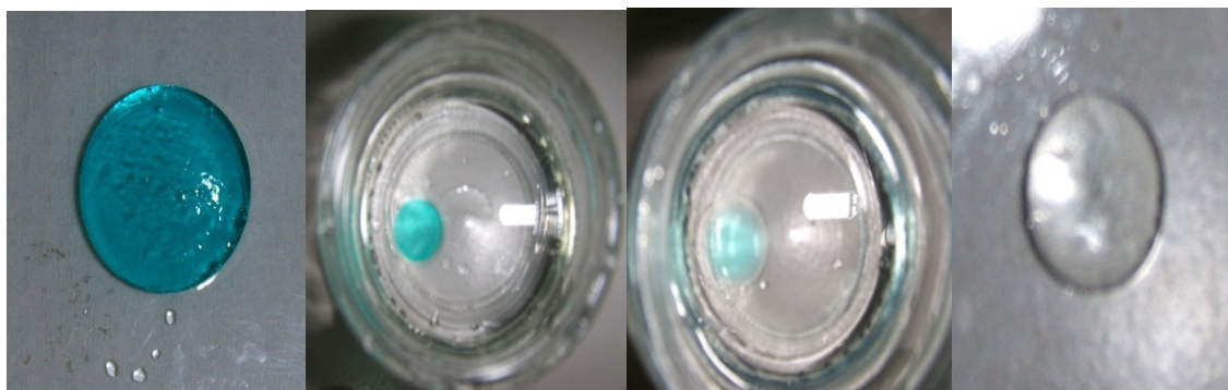
Figura 2. Desorción del hidrogel de poli (AAm-co-AAc), 60/40 después de haber estado sumergido en la sal de \text{Cu}^{2+} , en una solución de \text{HNO}_3 [11].
