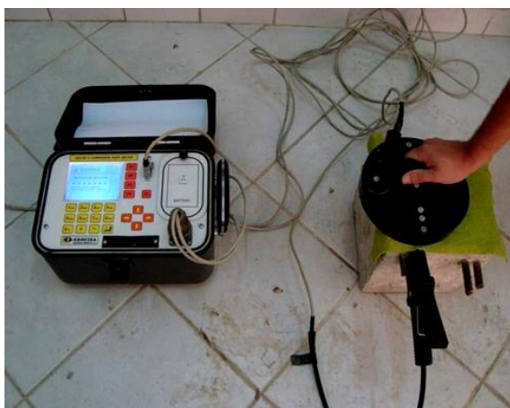
Figura 4. Sistema de medición empleado en las mediciones de intensidad de corrosión.
