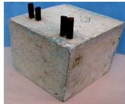
Figura 3. Tipo de probeta de hormigón armado para las tres relaciones agua/cemento.
