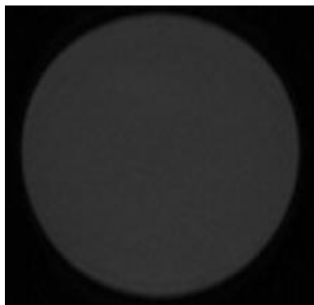
Figura 8. En la imagen se presenta el maniquí nuevamente irradiado para alcanzar una dosis de 300 Gy. Esta prueba se realizó para verificar la alteración de la respuesta una vez que la reparación del material tiene lugar y al mismo tiempo explorar la posibilidad de volver a usarlo como detector.
