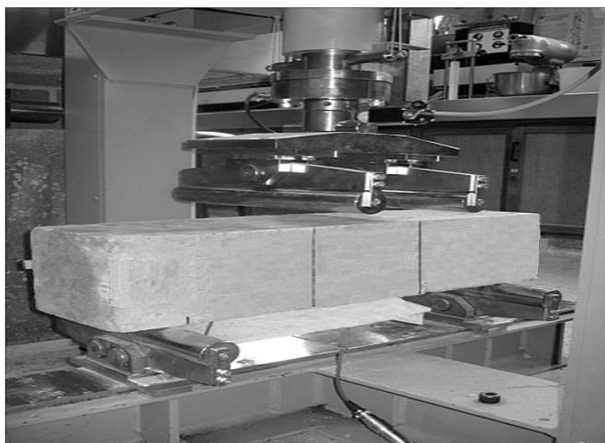
Figura 5. Configuración del ensayo de módulo de rotura.
