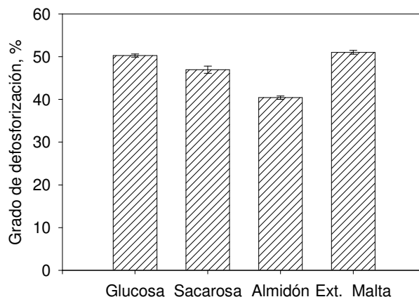
Figura 6. Efecto de la variación del tipo de nutriente (fuente de carbono) sobre la defosforización del mineral de hierro Jangada utilizando el hongo Aspergillus niger HNA-1 a un tiempo fijo de incubación de 10 días. Condiciones de incubación: 30 °C, 150 rpm. Tamaño de partícula del mineral: 0,1 mm. Todas las fuentes de carbono se añadieron a razón de 10 g/L.
