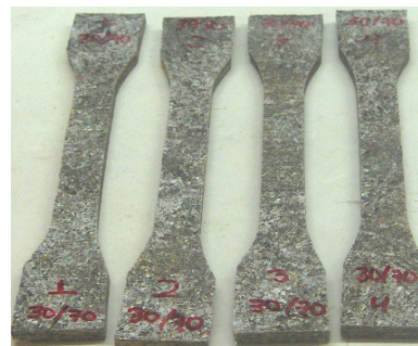
Figura 3. Aspecto de probetas troqueladas para ensayos de tensión ASTM D638 del compuesto.
