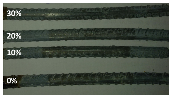
Figura 8. Aceros de Refuerzo de las diferentes muestras inmersas en Agua Potable
