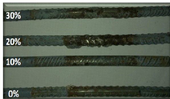
Figura 6. Aceros de Refuerzo de las diferentes muestras sometidas a Carbonatación.
