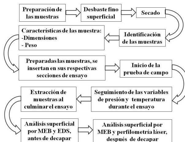
Figura 5. Esquema experimental empleado para la ejecución de este trabajo.
