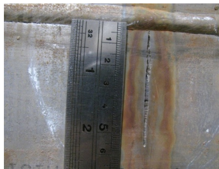
Figura 6. Detalle de serie de picaduras verticales.
