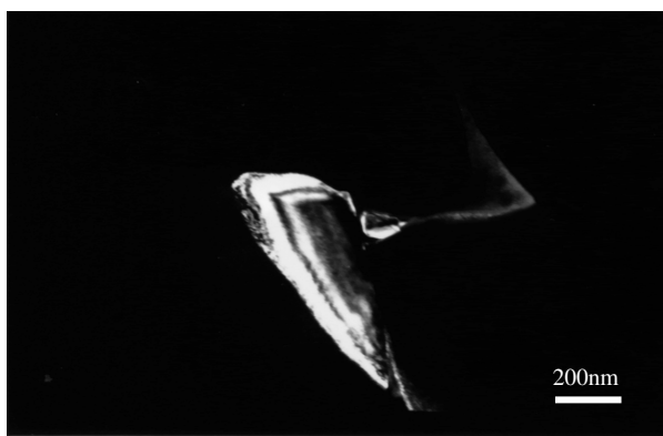
Figura 9A. Imagen de campo oscuro, -3^\circ , 50.000X de fase identificada como \text{Fe}_2\text{O}_3
