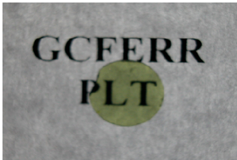
Figura 9. Exemplo típico de uma cerâmica ferroelétrica de PLT18, polida opticamente após prensagem a quente e tratamento térmico TT3, com espessura de 600 \mu\text{m} .
